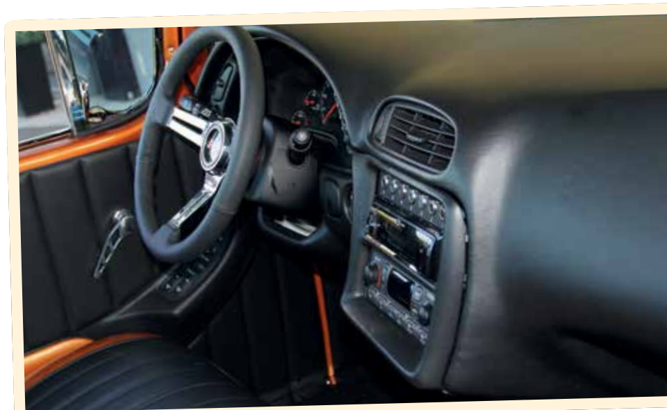
Hela instrumenteringen är hämtad från den Corvette C5 som levererat chassit till bygget. Knapparna högst upp ovanför stereon är däremot en egen lösning för att reglera automatlådan.
