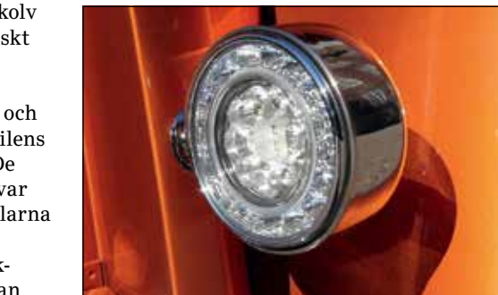
De rostfria kåporna runt bakljusen är ursprungligen små vattenskopor vilka modifierats lätt för att passa för sin nya funktion.
