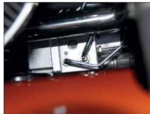
Enheten för ABS-bromsarna sitter numera monterad bredvid kylaren vilken även den är den ursprungliga från Corvetten.
