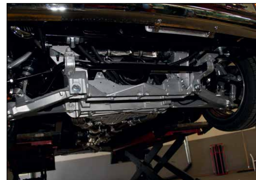
Automatlådan och bakaxelklumpen sitter samman på en Corvette C5.
