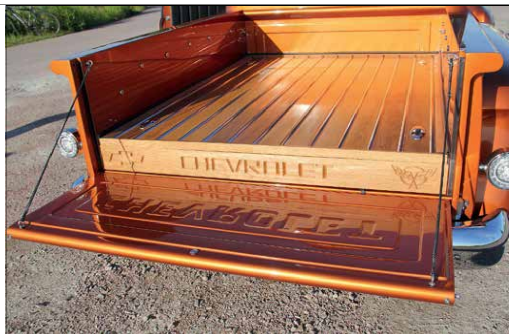
Den nya flakbotten av ek med ribbor i rostfritt sitter något högre än i originalutförandet. Notera träsnideriet längst bak.
