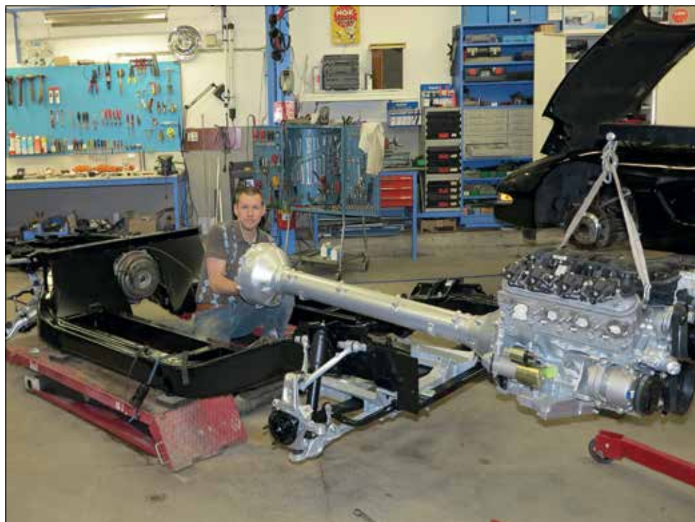
Ramen lackerad och framvagnen på plats. Dags att montera motorn i chassit. Notera det långa aluminiumröret mellan motorn och bakaxeln där även växellådan sitter.
