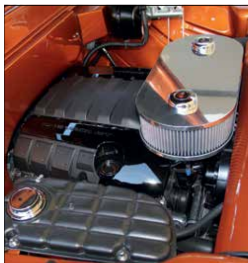
Insprutningsmotorn (LSI) på 346 cui är den som redan satt i C5-chassit. Luftrenaren är one of one och fräst ur ett massivt aluminiumstycke.
