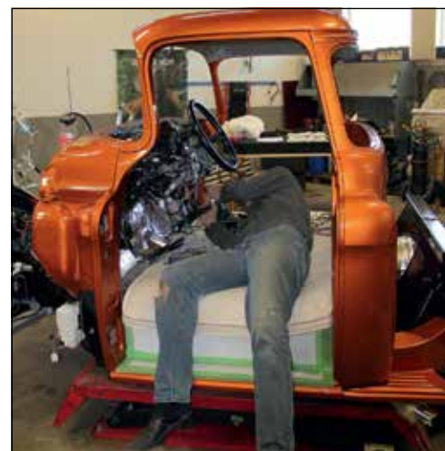
Hytten monterad på chassit och Niclas i full färd med att dra nytt elsystem.
