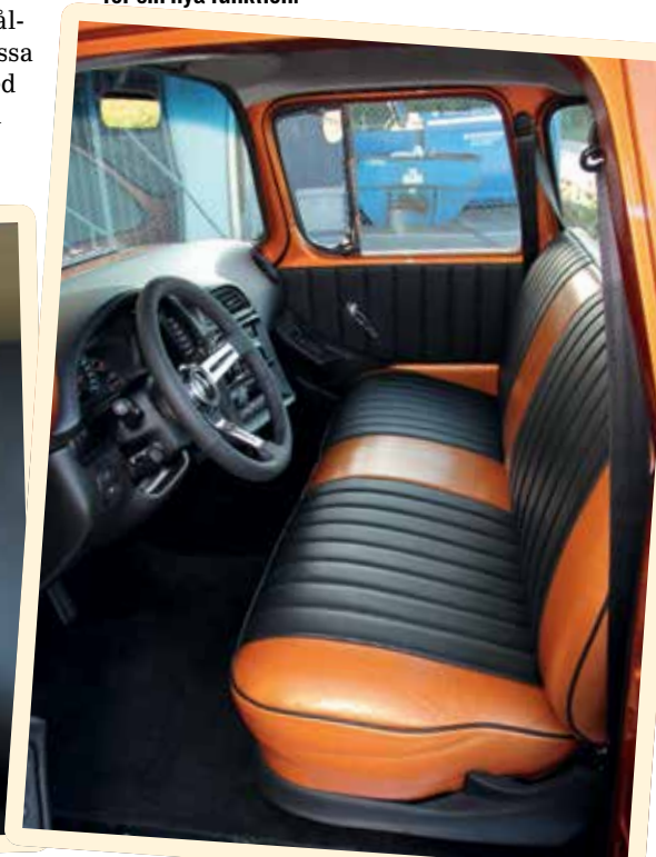
Soffan är hämtad från en nyare Cheva pickup. Den är omklädd i material som bland annat matchar lacken.
